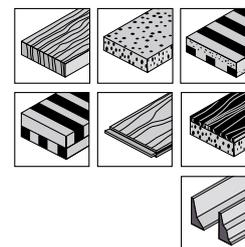
Je nach Grad der Verzahnung schnelle/ grobe, oder saubere Schnitte in Naturhölzern, Presshölzern, Schichthölzern, Tischlerplatten, furnierten Platten und Sperrhölzern. Für alle gängigen Tischkreissägen, Formatsägen und Abbundanlagen.
